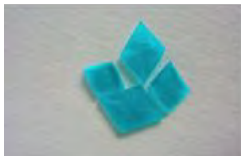
Figure 3 : cristaux de Ni(NH 4 ) 2 (SO 4 ) 2 · 6H 2 O produits après optimisation des étapes de purification (Photo X. Zhang).
