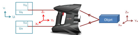
Figure 1: Exemple d'un système de reconstruction par stéréoscopie.
