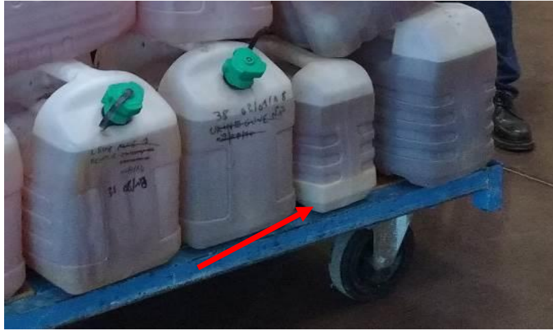
Figure 8 : Précipité collecté dans la cuve de stockage des urines, projet Azuris.
