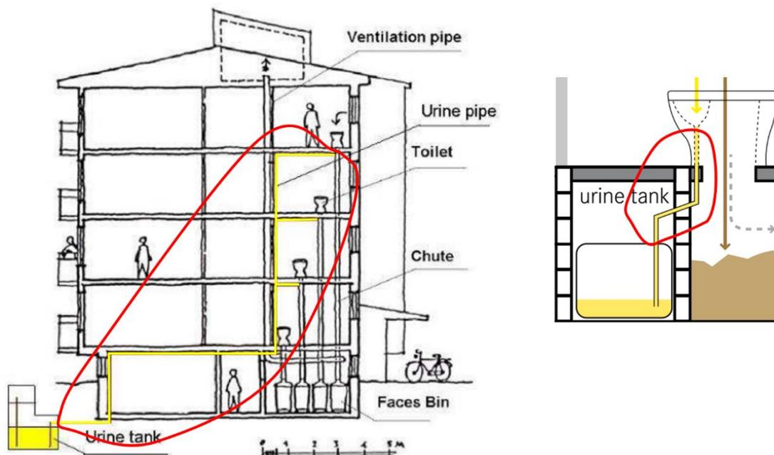
Figure 4 : Partie collecte correspondant au réseau d'urine dans le bâtiment. Crédits : (McConville et Rosemarin 2012; Tilley et al. 2014)
