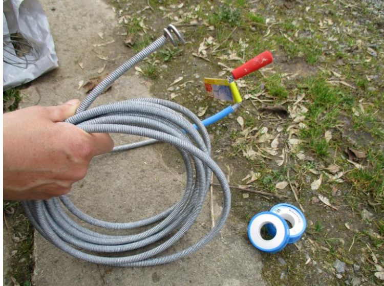
Figure 20 : Furet métallique souple et téflon. Crédit : Ecocentre Pierre et Terre
