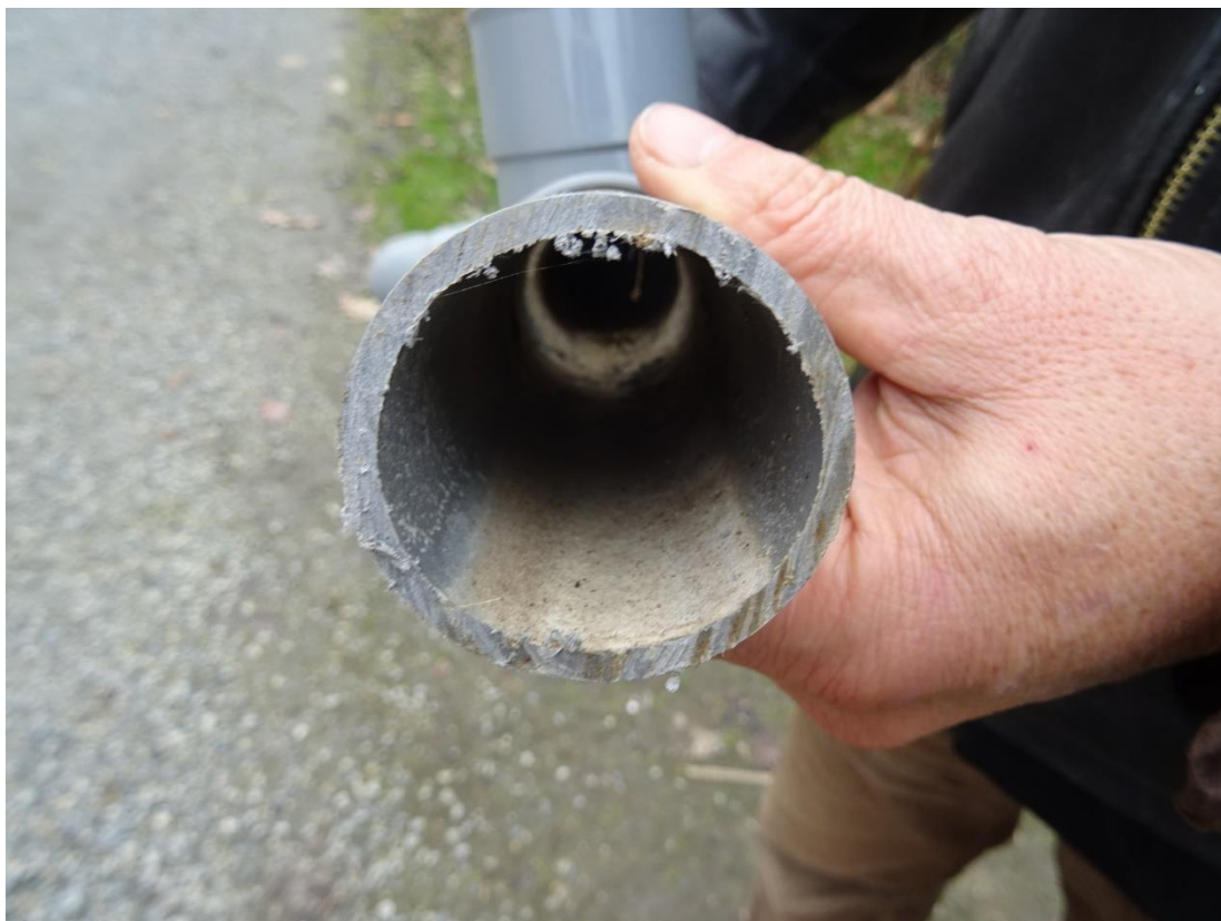
Figure 11 : Réseau après 12 ans de fonctionnement sans ajout d'intrant autre que de l'urine. Crédit : Ecocentre Pierre et Terre, 2022.
