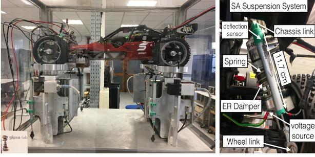
Fig. 10. The experimental testbed INOVE at GIPSA-lab (see [www.gipsa-lab.fr/projet/inove](http://www.gipsa-lab.fr/projet/inove))
