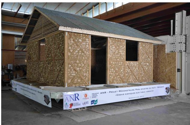
Fig 6. Essai sur table vibrante
