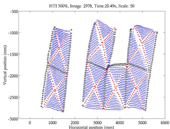
Fig 7. Champs de déplacement obtenu par corrélation d'images (3 fois l'intensité du séisme d'Haïti de 2010).
