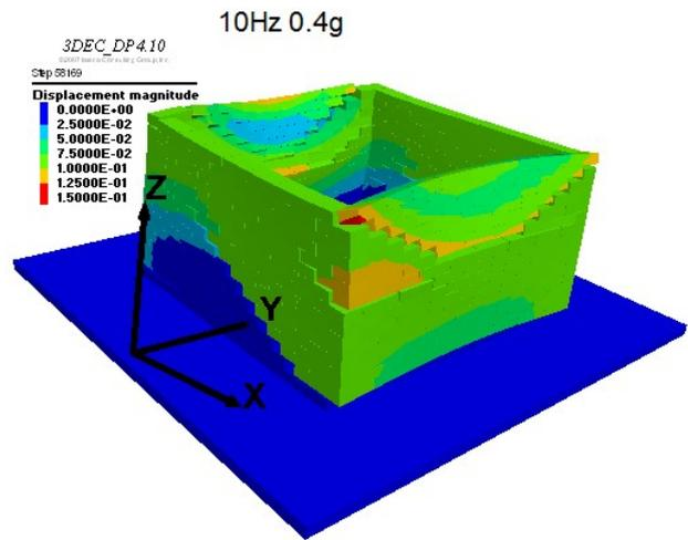
Fig. 9. Modèle par éléments discrets (comportement dynamique)
