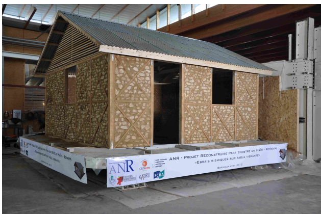
Fig 6. Essai sur table vibrante
