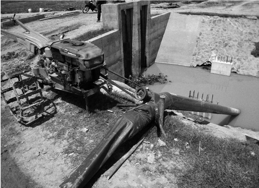
Figure 4.9. Pompe d'irrigation entraînée par un motoculteur (Ducourtieux, 2014).
