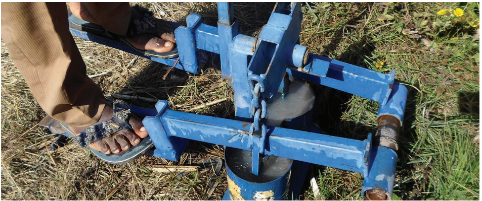
Photo 2.3. Importance du petit matériel d'irrigation : une pompe à pédale dans un petit périmètre irrigué des hauts plateaux du sud de la Tanzanie (Verhoog, 2014).
