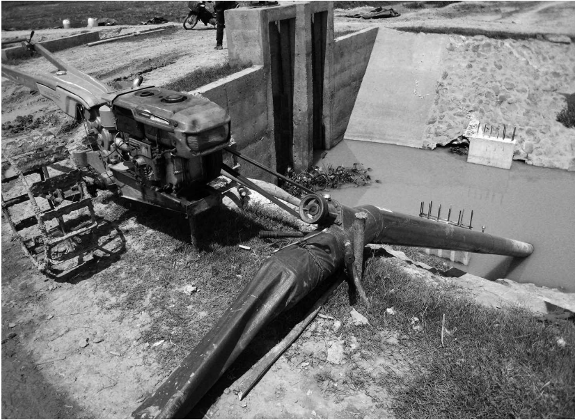
Figure 4.9. Pompe d'irrigation entraînée par un motoculteur (Ducourtieux, 2014).
