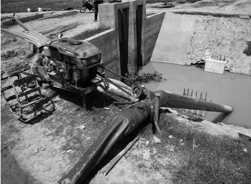
**Figure 4.9.** Pompe d'irrigation entraînée par un motoculteur (Ducourtieux, 2014).
