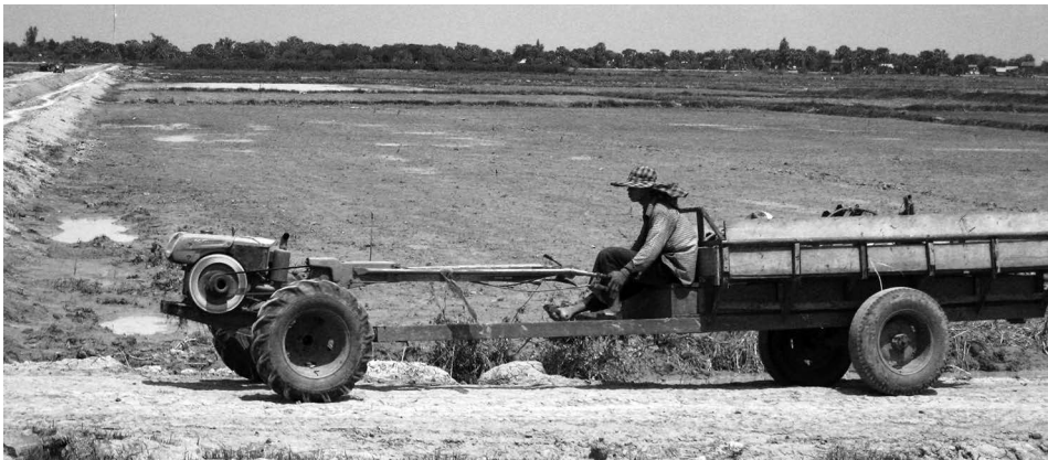
Figure 4.8. Motoculteur pour le travail du sol et le transport (Ducourtieux, 2014).
