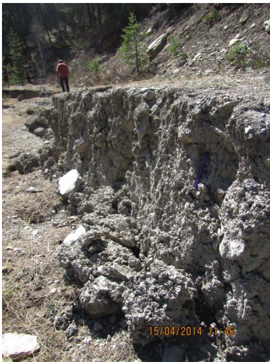
Photo C12 - C13 - glissement de Parpaillon (décalage de 80cm par rapport à avant le séisme)
