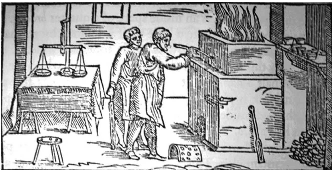
Figure 8 : Vannoccio Biringuccio, De la Pirotechnia , 1540, f 46v, éd. C. S. SMITH, M. T. GNUDI, p. 140, cette gravure est la seule illustration représentant le moufle.
