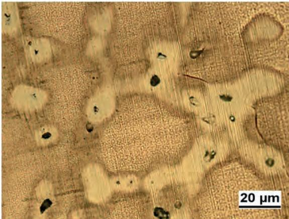
**Fig. 1** - Microstruttura del bronzo (attacco metallografico con soluzione di  $\text{FeCl}_3$ , osservazione al microscopio ottico).
