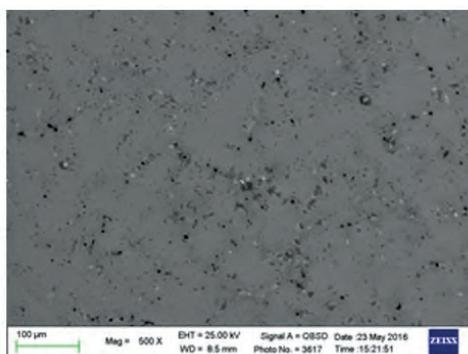
**Fig. 3** - Immagini al SEM ottenute con elettroni retrodiffusi su campioni di bronzo dopo immersioni in ARX10, sia in assenza di inibitori (a) che in presenza di SITP (b) o SITP+P (c).
