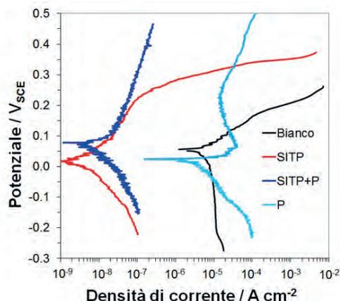
**Fig. 2** - Curve di polarizzazione registrate su elettrodi di bronzo dopo 20 giorni di immersione in ARX10, in assenza di inibitori e in presenza di SITP saturo, SITP saturo + 10<sup>-2</sup> M P e in presenza di 10<sup>-2</sup> M P.
