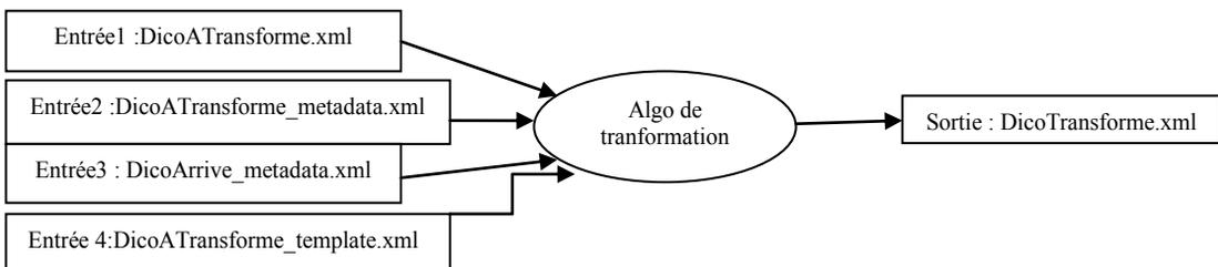
Figure 9: Arguments d'entrées et de sortie de l'algorithme de transformation
