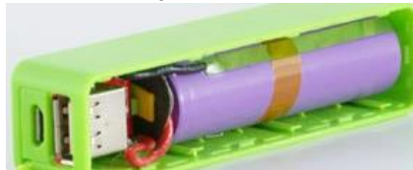
fig 12: USB Power Bank avec élément 18650
