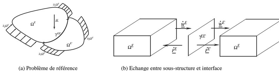
FIG. 1 – Référence et échange entre sous-structure et interface
