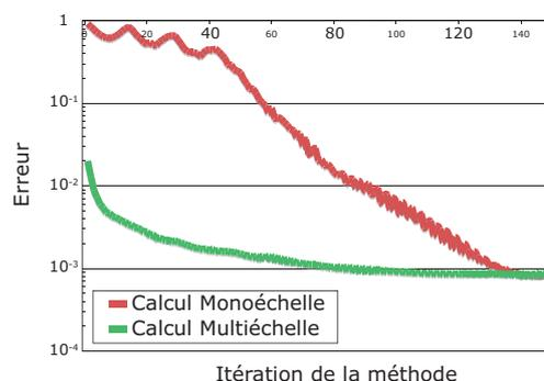
FIG. 4 – Courbe d'erreur des méthodes mono et multiéchelle
