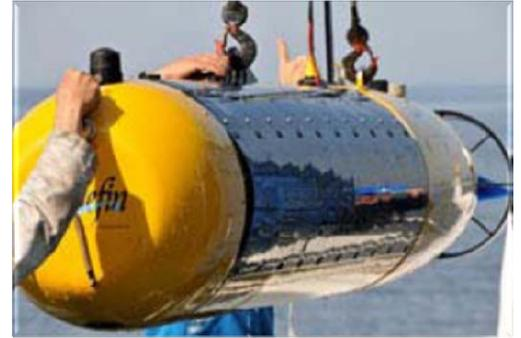
Fig. 6 - Bluefin AUV
