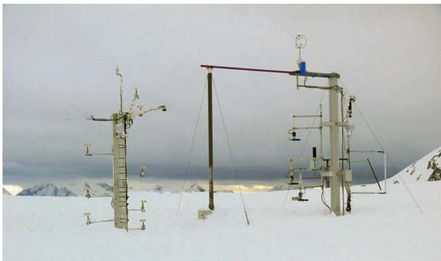
Figure 4. Banc de mesures de transport de neige par le vent. Crédit : H. Bellot, Irstea.
