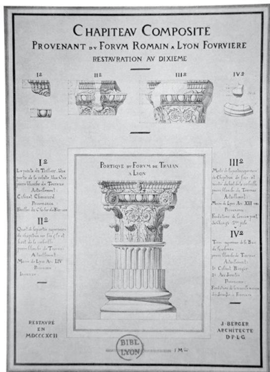
Fig. 12. Restitution d'une colonne du "forum" par J. Berger d'après des fragments (Berger 1904). En haut, de gauche à droite et de haut en bas : fragments de chapiteaux composites n° 6 et 5 ; chapiteau composite n° 8 ; chapiteau composite n° 7 ; fragment de base attique en calcaire oolithique recueilli lors des travaux pour la construction de la "nouvelle maison des Jésuites à Fourvière" et que nous avons exclu.
