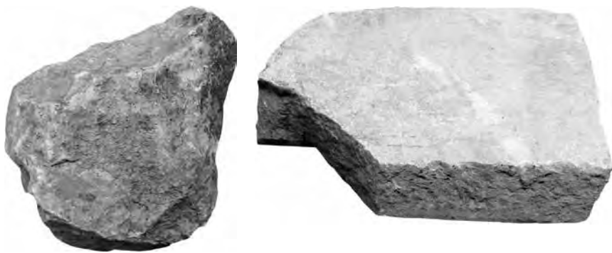
Fig. 16. Dos piqueté ou lisse de placages de colonne avec des vestiges du mortier de scellement, conservés au musée Saint-Raymond (cl. D. Cazes).
