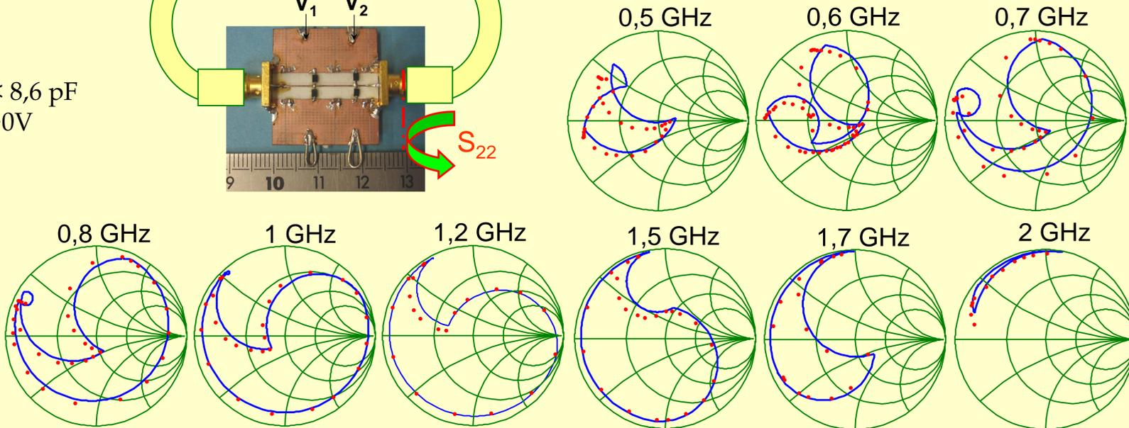
Simulations et mesures des charges permettant :  $|S_{11}| < -20$  dB et  $|S_{22}| > -2$  dB
