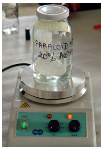
30 а: взвешенная смола помещена в марле; б: банка поставлена на смеситель; с: маркировка контейнера (фото: Э. Оттенвельтер).
