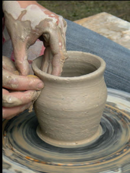
6 а: центрирование глиняного шара; б: вытягивание стенок сосуда (фото: Э. Оттен-вельтер, МАФtur).
