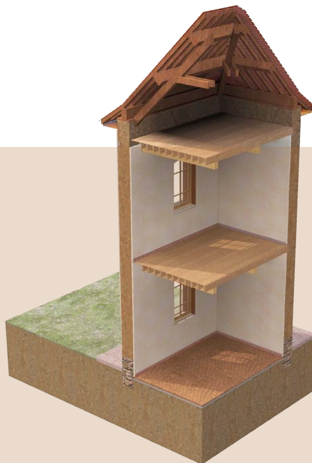
Une fois la structure achevée, les traitements de surface sont mis en place en prenant soin de maintenir un système perspirant*.
