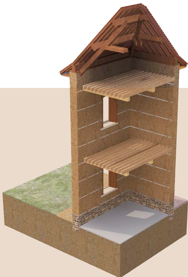
Les éléments de plancher sont mis en place dans le pisé, et la charpente (ici à coyaux) et la couverture sont rapidement réalisés pour ne pas laisser les élévations prendre l'eau.
