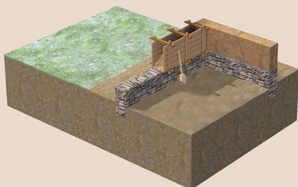
*Les élévations en pisé sont réalisées par compaction de la terre sur les soubassements. Ils permettent d'assurer l'assise du bâtiment et l'évaporation des remontées capillaires à leur surface.*
