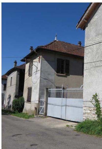
*Les travaux de ravalement sont rarement adaptés au support pisé (enduits ciments et grillages non conformes aux règles professionnelles).*
