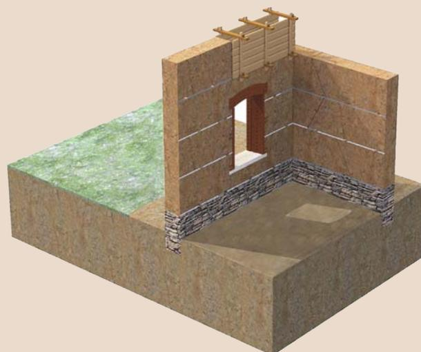
*Banchée après banchée, les murs s'élèvent. Des cordons de chaux peuvent être mis en place entre chaque banchées, et les percements des ouvertures sont traités dans le pisé aux endroits prévus.*
