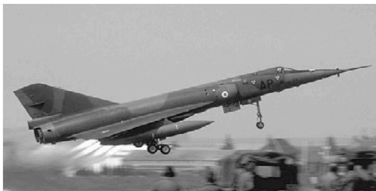
Un Mirage IV décolle poussé par ses fusées JATO (Photo: armée de l'air)
