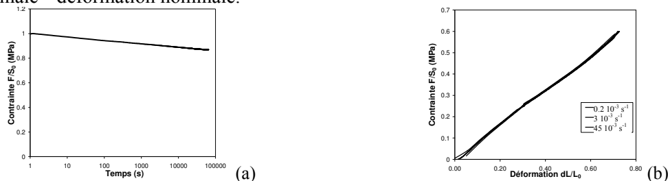
Figure 7 : Influence des paramètres temps et vitesse sur le comportement mécanique du silicone : (a) essai de relaxation (traction à 55 %), (b) essai de traction cyclique (charge-décharge) à 3 vitesses
