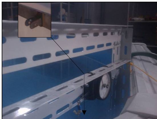
Figura 2.7 – Apprestamento per prova di propulsione del sottomarino
