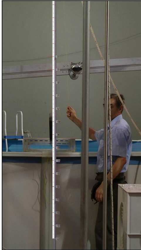
Figura 2.5 – a) Posizionamento della telecamera HD con l'ausilio di puntatore laser e b) metro lineare sovrapposto successivamente alla ripresa per leggere il dettaglio dei millimetri tra le decadi di centimetri
