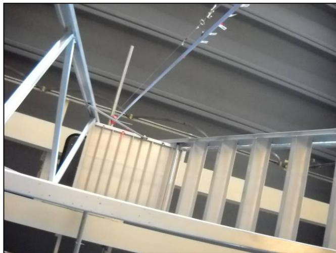
Figura 2.3 – Sistema di riaddrizzamento del filo inestensibile e riporto verticale della misura
