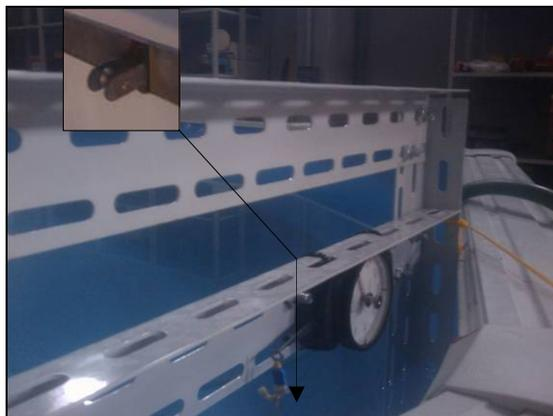
Figura 2.7 – Apprestamento per prova di propulsione del sottomarino
