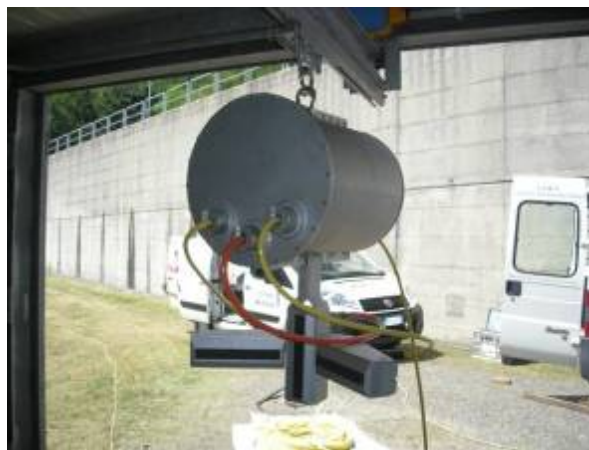
Figura 1 - Il sistema STSS500: Elettronica di controllo ed antenne trasmettenti e ricevente.
