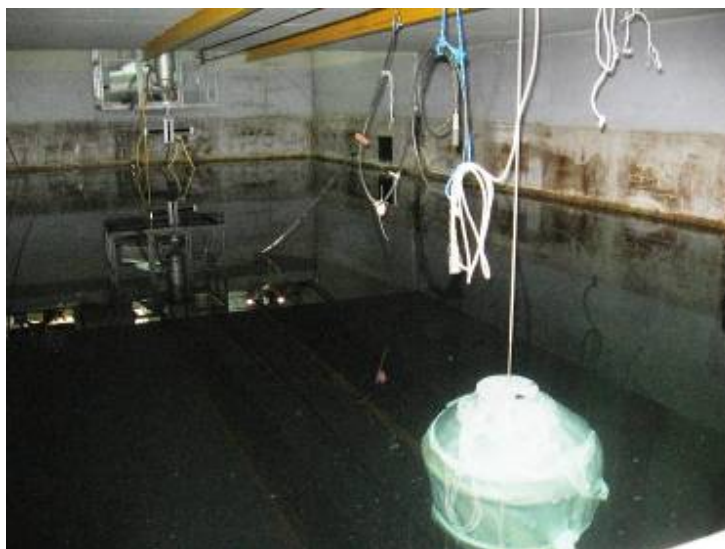
Figura 3 - STSS500 in prova, nella piscina sullo sfondo, con bersaglio cilindrico in primo piano.
