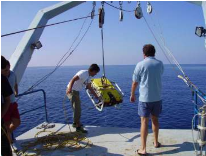
Figura 7 – Il ROV Falcon durante l'alaggio.
