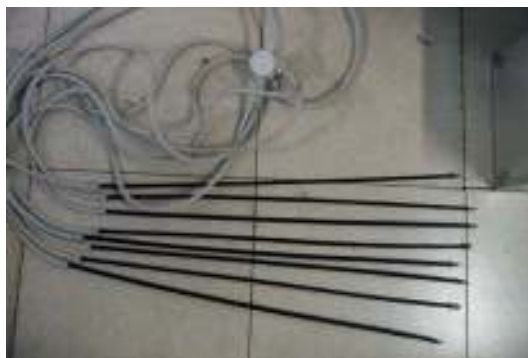
Figura 5 – Sonde di temperatura- alloggiamento nella struttura che garantisce la robustezza meccanica e particolare della testa.
