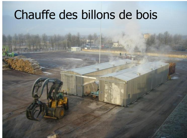
Coupe orthogonale par outil tranchant et chauffe ente 40 et 80°C
