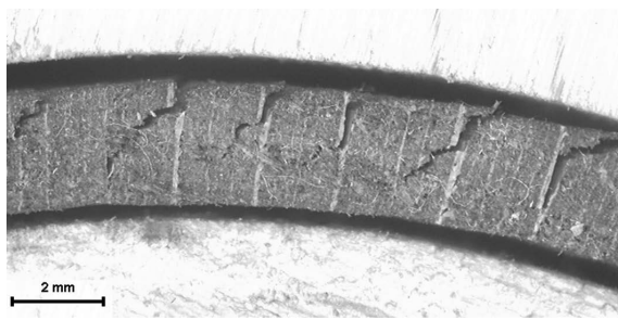
Figure 10.4.31. Fissuration périodique d'un placage de hêtre.
