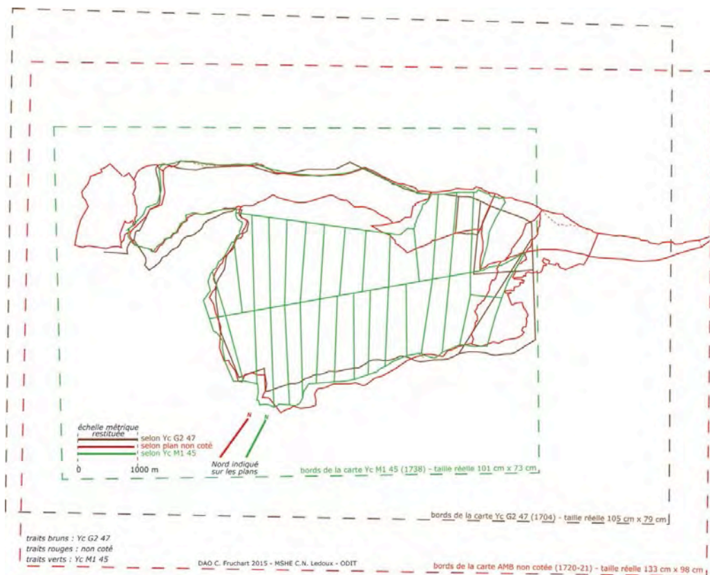
Figure 10. Digitalisation et superposition des plans de 1704, 1720-21 et 1738 de la forêt de Chailluz : comparaison des échelles, de l'orientation du Nord et des limites de propriété et de parcelles indiquées.
