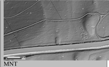
3 - Pour connaître la hauteur des éléments situés au-dessus de la surface du sol, on effectue la soustraction pixel par pixel des valeurs d'élévation entre les deux modèles précédemment cités :  $H_n = Z_n (MNS_{hmax}) - Z_n (MNT)$
