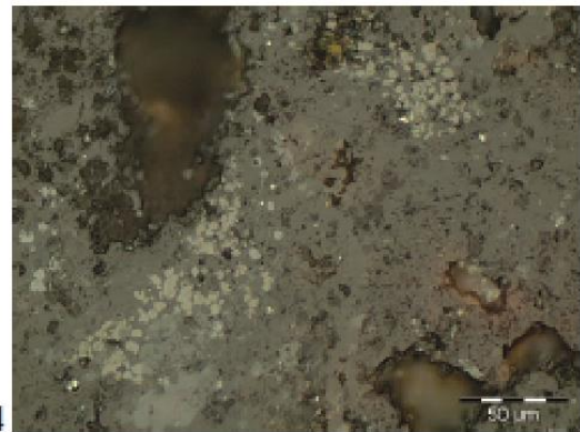
Battitures lamellaires en cours de dissolution
