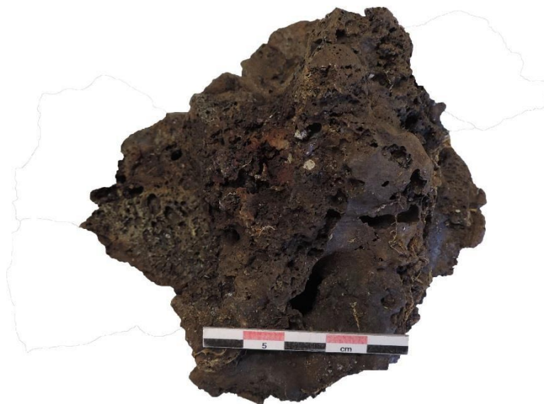
Figure 25. Forêt de Boulogne, fragment de scorie de fond de four, ferrier 155/1
