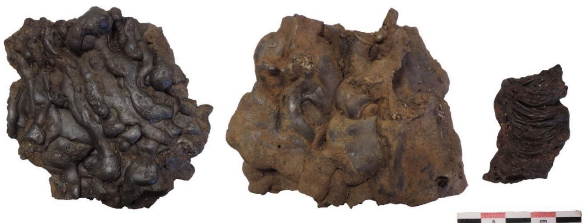
Figure 21. Forêt de Boulogne, scories coulées en cordons fins, en cordons larges et en cordons ridés
