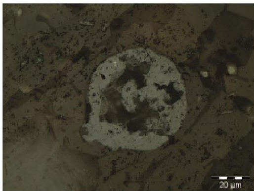
Battiture globulaire (magnétite massive)
