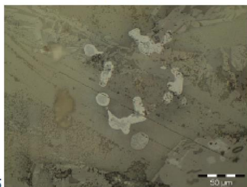
Battiture globulaire en cours de dissolution
