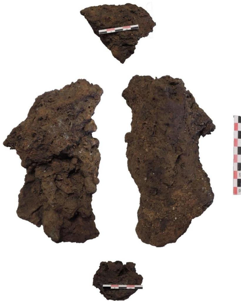
Figure 22. Forêt de Boulogne, faces supérieure et inférieure et coupes d'une scorie coulée dans un canal, ferrier 145/1
