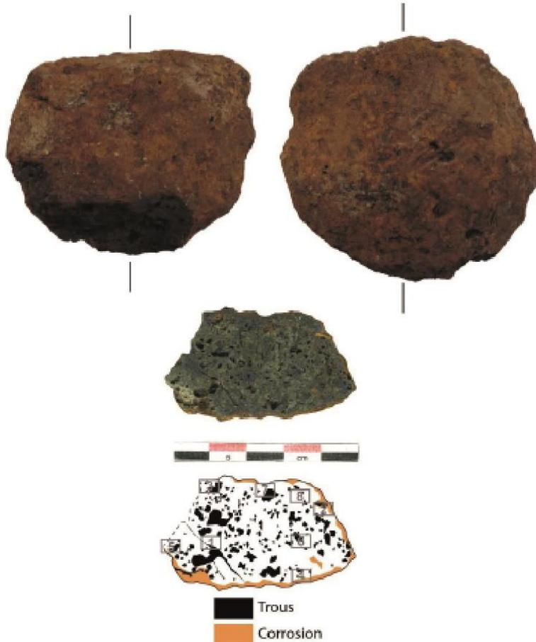
*Métrie / Morphologie :* Culot de forge plano-convexe de type SFR quasi-complet mesurant 5,7 cm de longueur, 4,8 cm de largeur et 3,2 cm d'épaisseur. D'un magnétisme moyen, il pèse 132 g. Son orientation par rapport à l'axe de la tuyère est dans le sens de la largeur.
