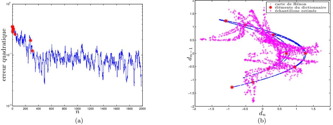
FIG. 1 – Evolution de l’erreur quadratique (a) entre la sortie désirée  $d_n$  et celle estimée  $\psi(d_{n-1}, d_{n-2})$ , pour  $\mu_0 = 0.1$ . Les deux séries sont comparées en (b) dans le plan de phase. Les éléments du dictionnaire sont indiqués par des étoiles.
