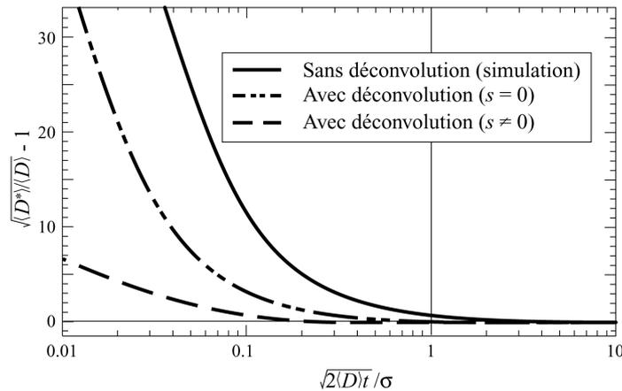
**Figure 3.** Erreur entre le coefficient de diffusion moyen réel,  $\langle D \rangle$ , et le coefficient de diffusion moyen apparent,  $\langle D^* \rangle$ , en fonction du rapport entre la profondeur de diffusion réelle moyenne,  $\sqrt{2\langle D \rangle}t$ , et l'écart type de la zone de mesure,  $\sigma$ , pour un couple de diffusion nickel/cuivre.
