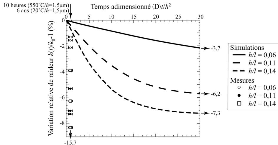
**Figure 4.** Evolution relative de la raideur des soufflets en fonction du temps par simulation de vieillissement par diffusion et par mesures sur des composants vieillis à température ambiante pendant six ans (Sénéchal, 2002).
