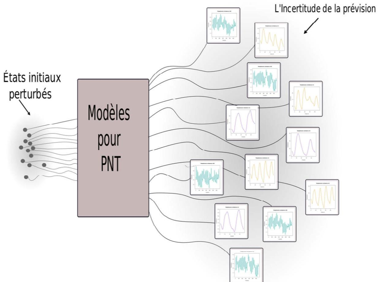
Figure 2 : Principe de la prévision d'ensemble pour les prévisions météorologiques.
