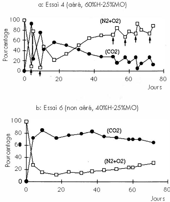
Figure 4 : Suivi de la teneur en CO<sub>2</sub> et (N<sub>2</sub> + O<sub>2</sub>) dans deux essais représentatifs. Pour l'essai 4, les flèches symbolisent les aérations réalisées au début et à la fin de l'essai.
