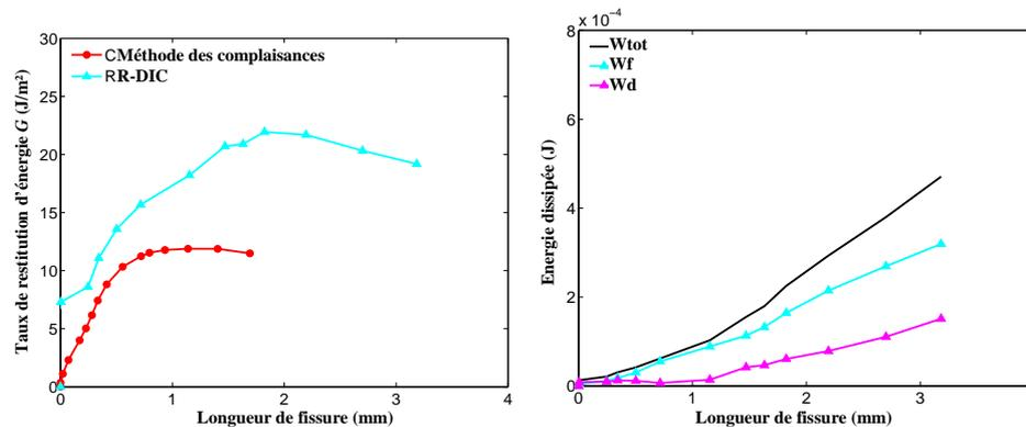
FIG. 5 – Taux de restitution d'énergie  $G$  et énergies dissipées  $W$  pendant la fissuration
