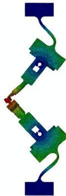
Figure 2.4 : déformée modal du 5 ème mode du banc PREMECCY utilisé pour les essais. La fréquence est de 331 Hz.
