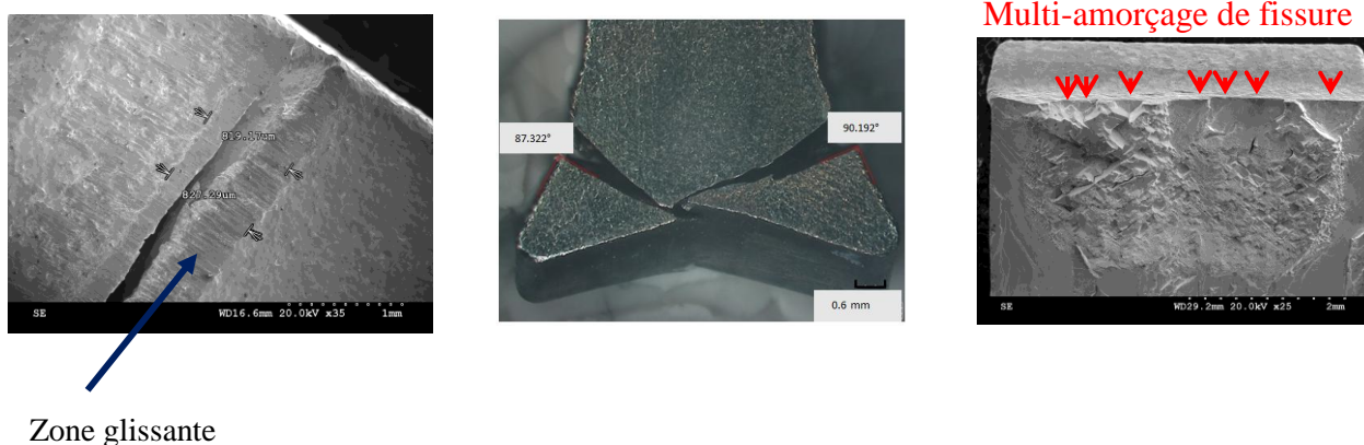
Figure 2.5 : faciès de rupture de l'éprouvette queue d'aronde après 10^6 cycles.
