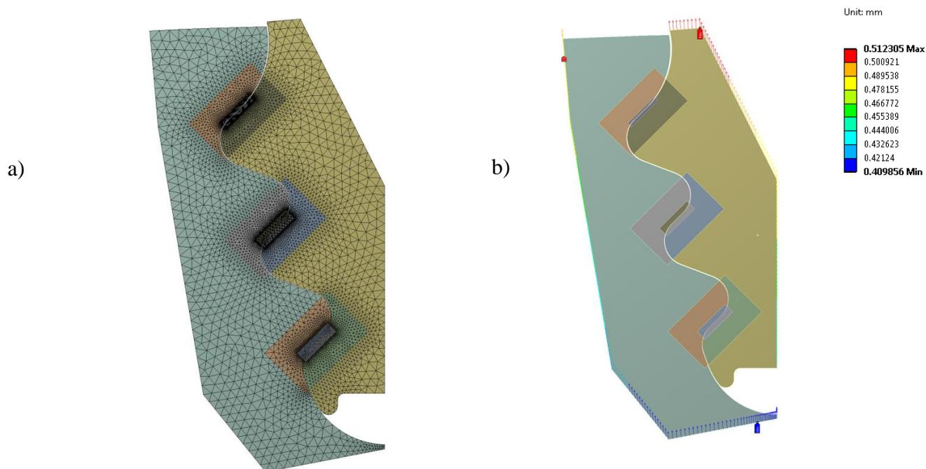
Figure 4.3 : a) maillage (40.006 nœuds au total) et b) import du champ de déplacement 3D sur le modèle d'attache pale-disque 2D
