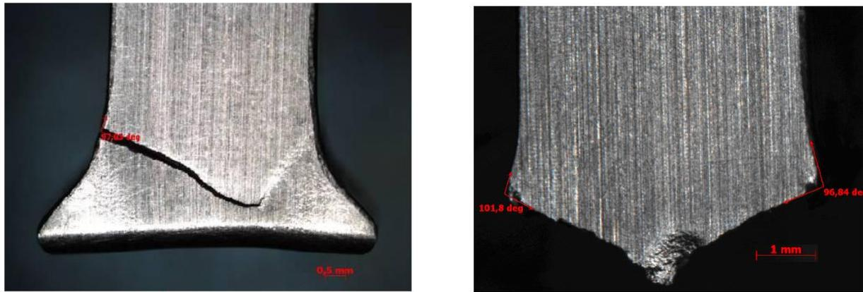
Figure 2.3 : ruptures de deux éprouvettes queue d'aronde différentes après un chargement LCF sinusoïdal.
