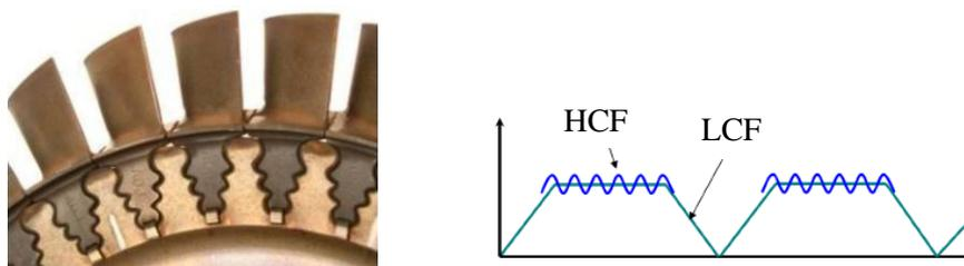
Figure 1.2 : liaison pale/disque soumise à un chargement combiné LCF + HCF Durant un vol.
