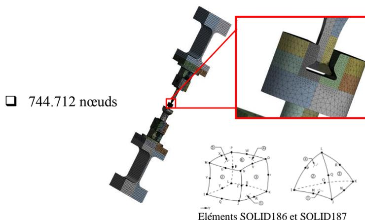
Figure 3.1 : modèle éléments finis 3D du banc PREMECCY
