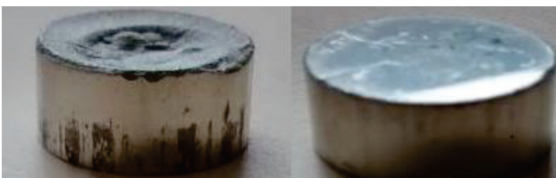
Figure 2: Pastille d'étain pur après démoulage. Les vitesses de pressage sont respectivement de 1mm/min à gauche et 0,1mm/min à droite.
