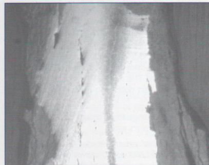
Fig. 4 — Macrographie. Coupe longitudinale de la flèche PM 594. Soudure de la barbelure. L'extrémité de la pointe est pliée et soudée au corps de la flèche.
