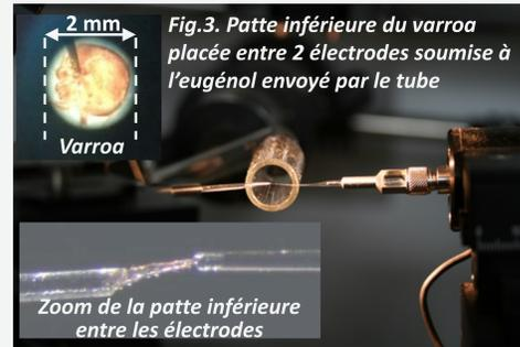
Fig. 3. Patte inférieure du varroa placée entre 2 électrodes soumise à l'eugénol envoyé par le tube
