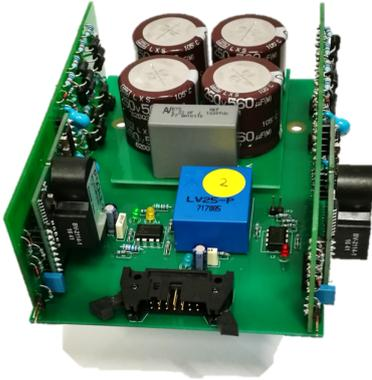
Fig. 3. Photographie d'un module du prototype MMC.
