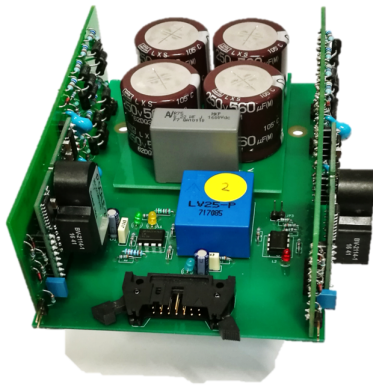
Fig. 3. Photographie d'un module du prototype MMC.
