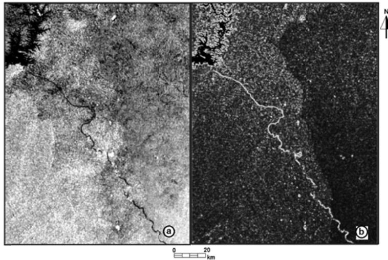
Figure 4. Paramètres de texture préservant les linéaments et les morphostructures dans l'image RADARSAT-1 : a) Paramètre « moyenne », b) paramètre « variance »
