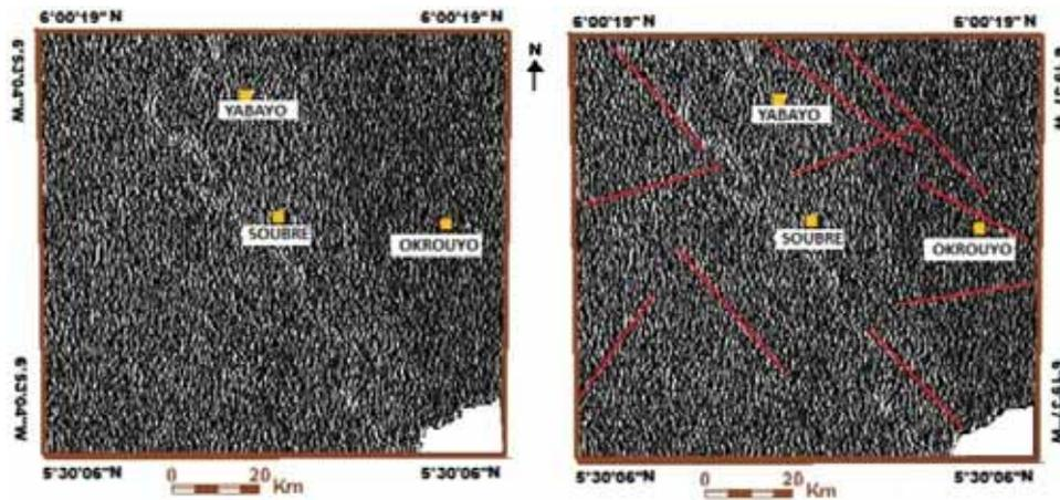
Figure 6a. Filtrage directionnel Sobel (N-S) et extraction de quelques linéaments (image RSO RADARSAT-1)
