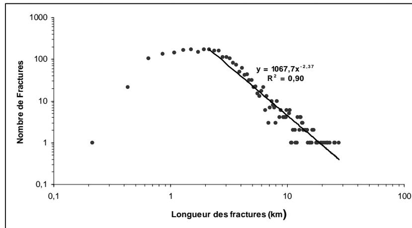
Figure 9. Représentation bi logarithmique de la distribution de longueur des fractures
