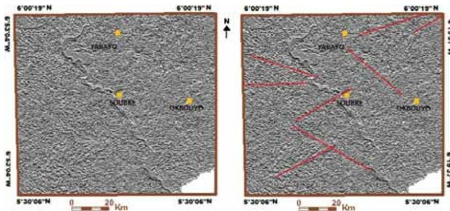
Figure 6b. Image PC1 traitée par filtrage Sobel dans la direction NE-SW et extraction de quelques linéaments
